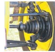
Querblattfeder und Dreieckslenker führen die per Gelenkwelle angetriebene Vorderachse.
